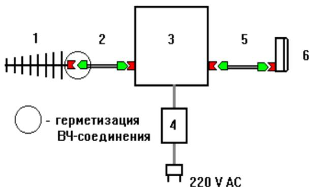
При монтаже ретранслятора используйте крепёж из комплекта поставки. Длина соединительных кабелей должна быть как можно короче, чтобы вносимое затухание сигнала было минимальным, но натяжение кабелей не должно быть чрезмерным. Подсоедините разъёмы кабелей от антенн к соответствующим разъёмам ретранслятора. Внутренние поверхности ВЧ разъёмов должны быть чистыми. Подключите шнур питания к сети. Шнур питания должен быть проложен свободно, без натяжения.
